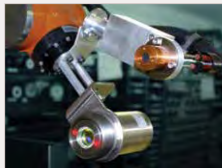
K展后新的双探头, 热流量探头和非接触式红外线热电偶探头
