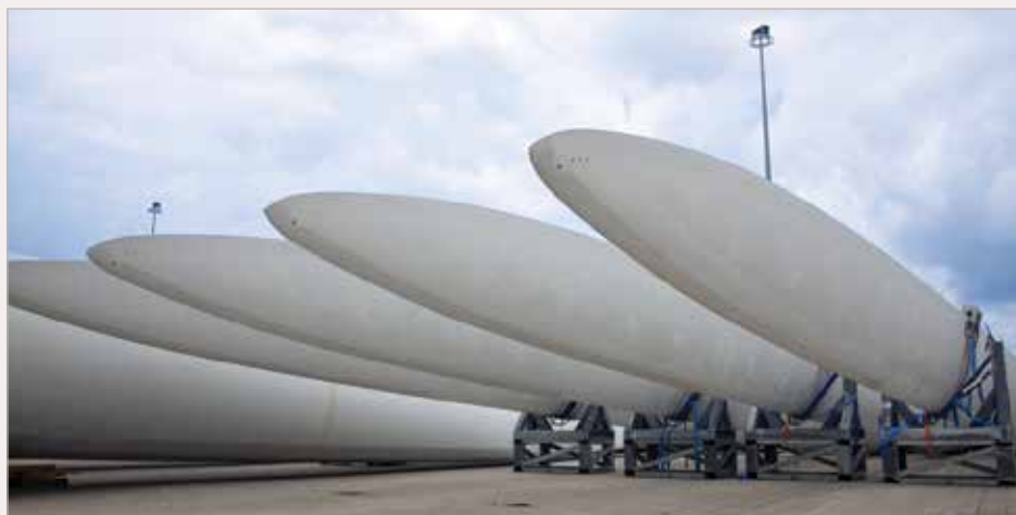
复合材料风力涡轮机叶片正等待装配
